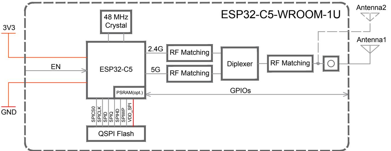
图 2: ESP32-C5-WROOM-1U 功能框图
