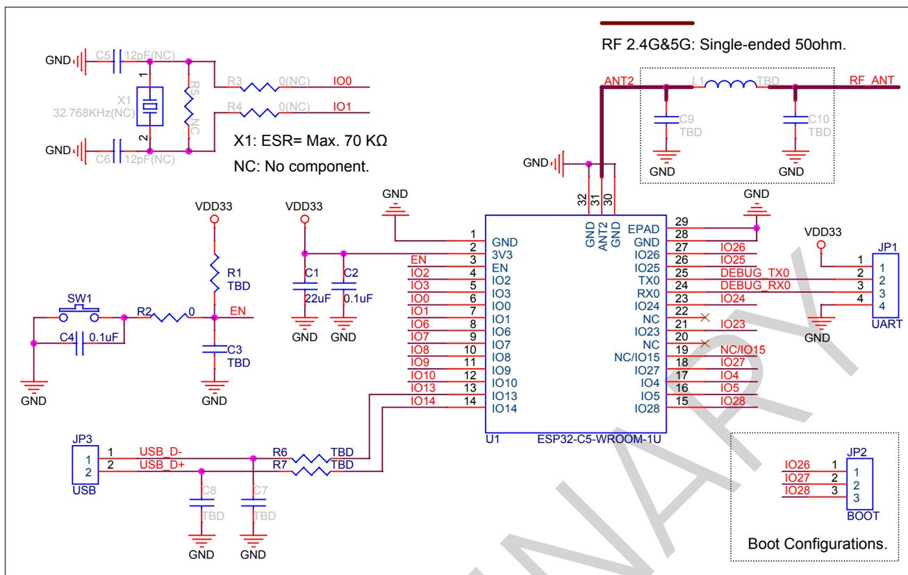
图 9: ESP32-C5-WROOM-1U 外围设计原理图
