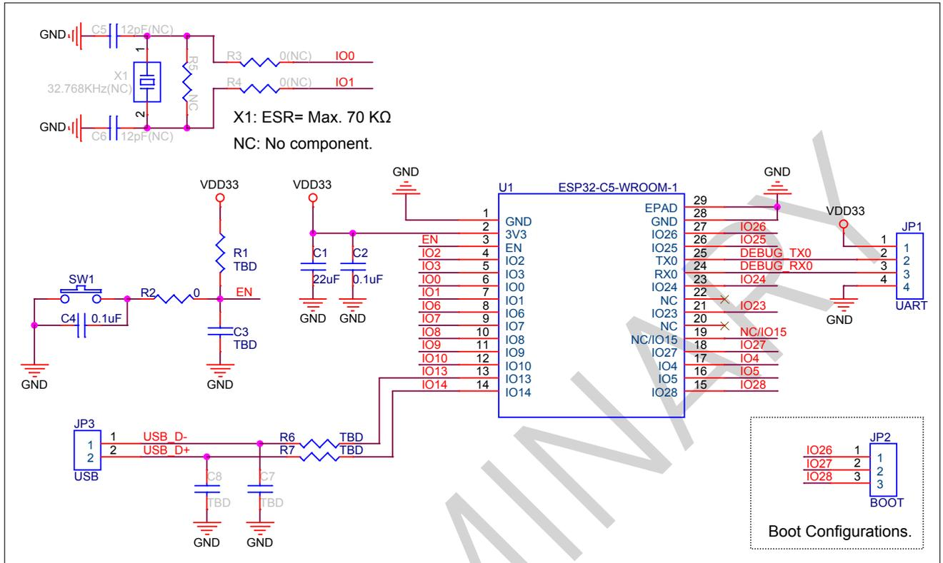
图 8: ESP32-C5-WROOM-1 外围设计原理图
