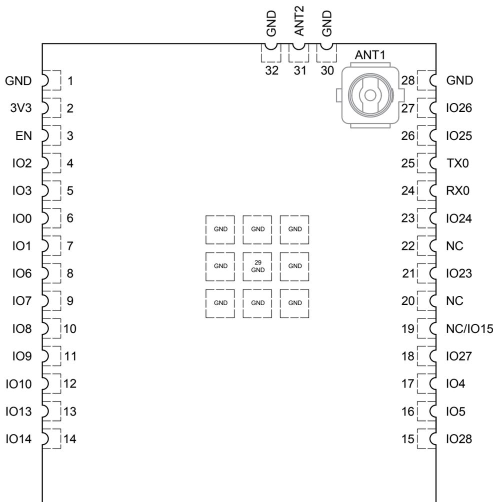
图 4: ESP32-C5-WROOM-1U 管脚布局 (顶视图)
