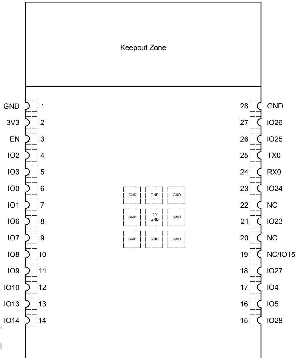
图 3: ESP32-C5-WROOM-1 管脚布局 (顶视图)
