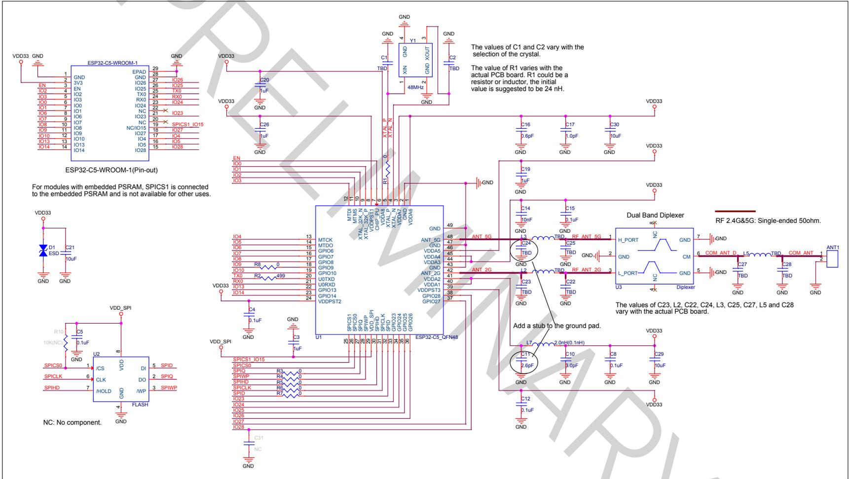
图 6: ESP32-C5-WROOM-1 原理图
