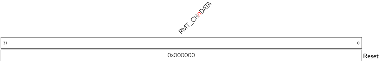
Register 32.1. RMT_CHnDATA_REG (n: 0-3) (0x0000+0x4*n)
