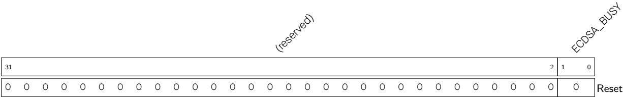
Register 22.8. ECDSA_STATE_REG (0x0020)
