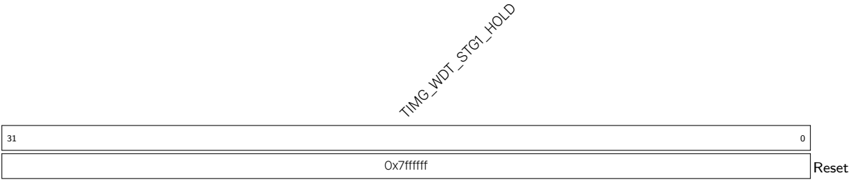
Register 10.13. TIMG_WDTCONFIG3_REG (0x0054)
